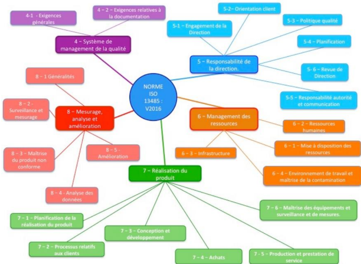
Figure 7 : Cartographie des processus de la norme ISO 13485 : 2016 [22]
