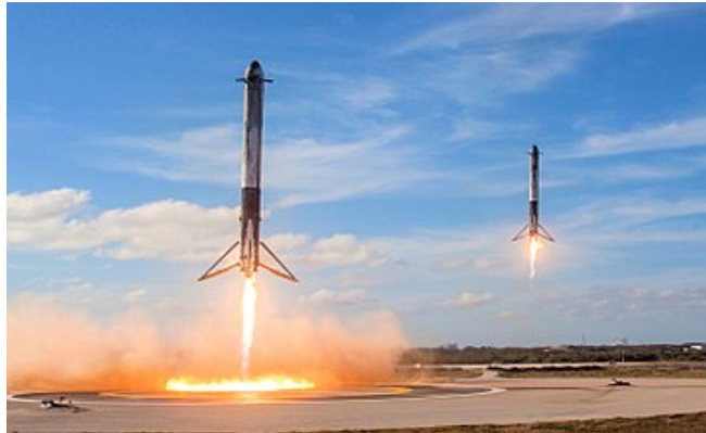
Figure 24: Atterrissage en "Suicide Burn" du lanceur Falcon
