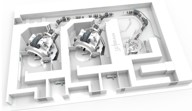
Figure 32 : Schéma d'une installation de protonthérapie de deux salle de traitements (à gauche) et d'un accélérateur de particule (à droite)[54]
