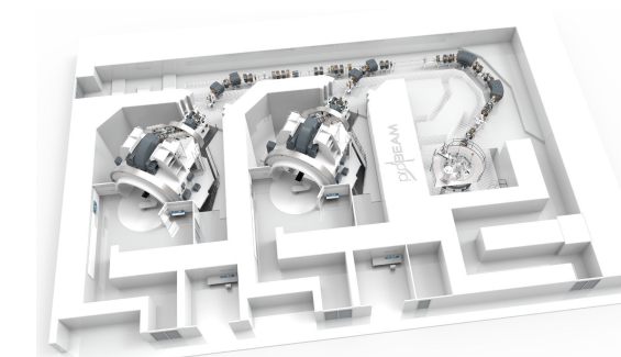
Schéma d'une installation de protonthérapie de deux salle de traitements (à gauche) et d'un accélérateur de particule (à droite). Source : https://www.varian.com/fr/products/proton-therapy
