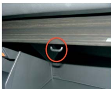
Exécution d'un détail dans une voiture haut de gamme : aspect agressif et pauvre de la gâche de fermeture
