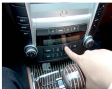
Interface homme-machine : problème d'accessibilité et de bruit d'actionnement non qualitatif
