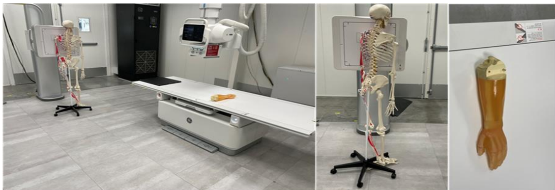
Figure 19: Table radiologique & Fantômes tests (source auteur)
