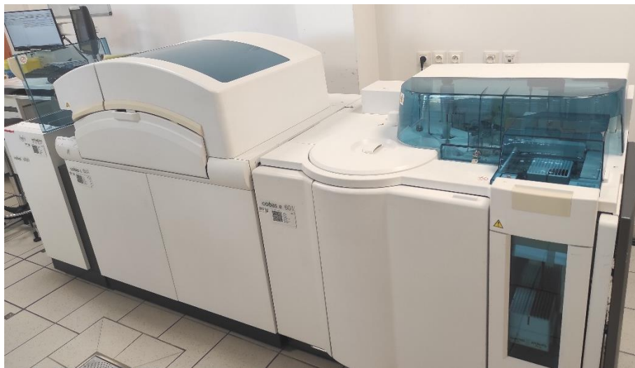
Figure 7 : Automate d'analyse présent au laboratoire de biologie médicale du CHAC comprenant un module de biochimie et un module d'immunologie
