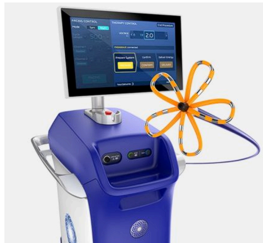
Figure 13 : Console Farastar et cathéter farawave déployé en Fleur [16]
