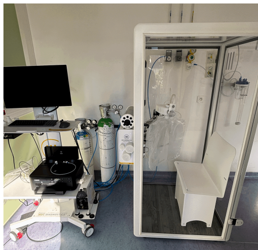
Figure 12 : Cabine de pléthysmographie à la Pitié-Salpêtrière (Source : auteurs)
