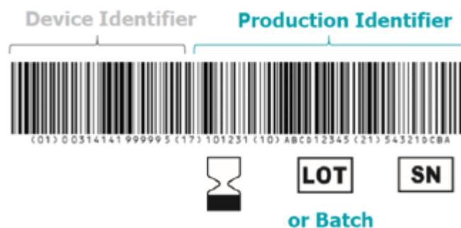
Figure 8: Illustration de la mise en place de l'IUD-ID et l'IUD-IP [13]
