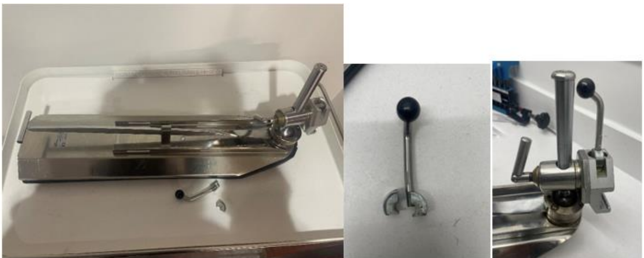
Figure 20 : Appui-bras cassé à gauche puis réparé à droite (source : auteur)
