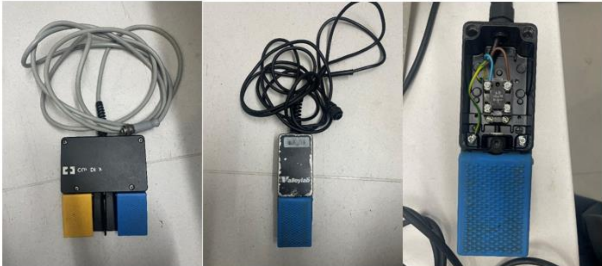
Figure 19 : Pédales monopolaire et bipolaire (de gauche à droite) (source : auteur)
