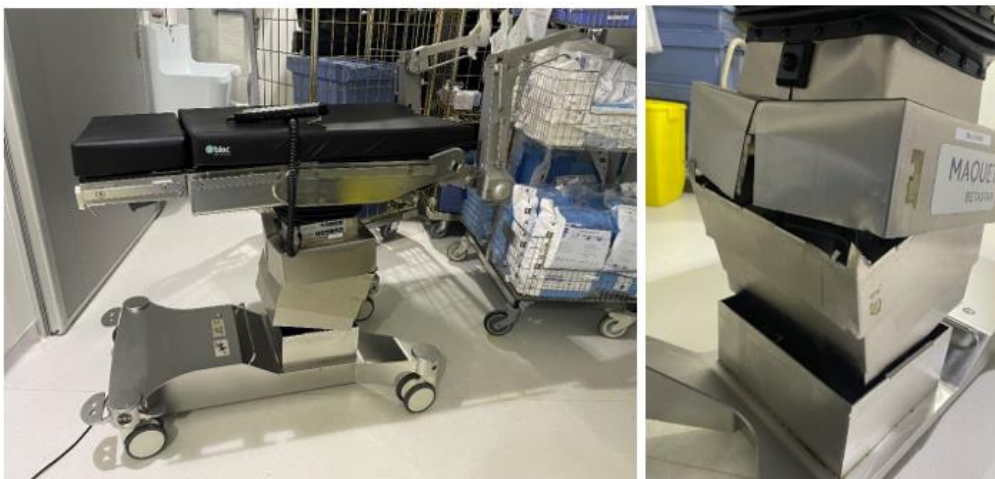
Figure 24 : Table d'opération avec les capots détériorés (source : auteur)
