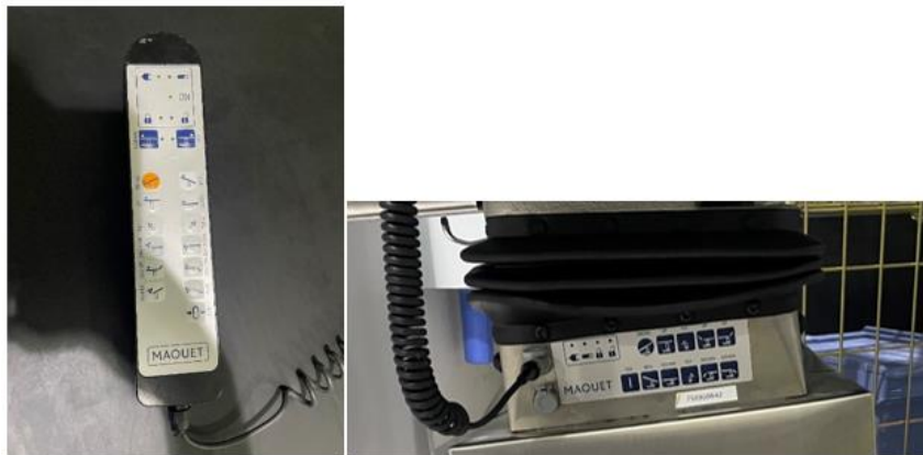
Figure 22 : Télécommande et commandes de secours (de gauche à droite) (source : auteur)
