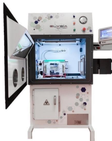
Fig. 9 : Enceinte blindée Radioprotech F750
