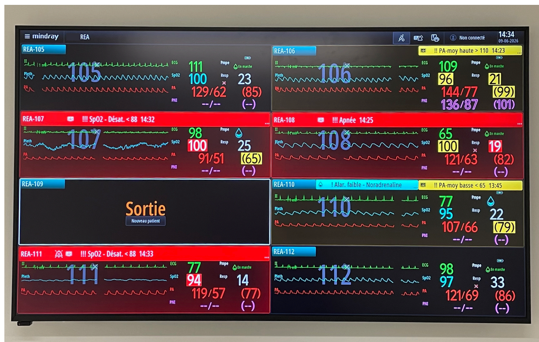
Figure 10 : Interface de centrale de surveillance avec accumulation d'alarmes non acquittées
