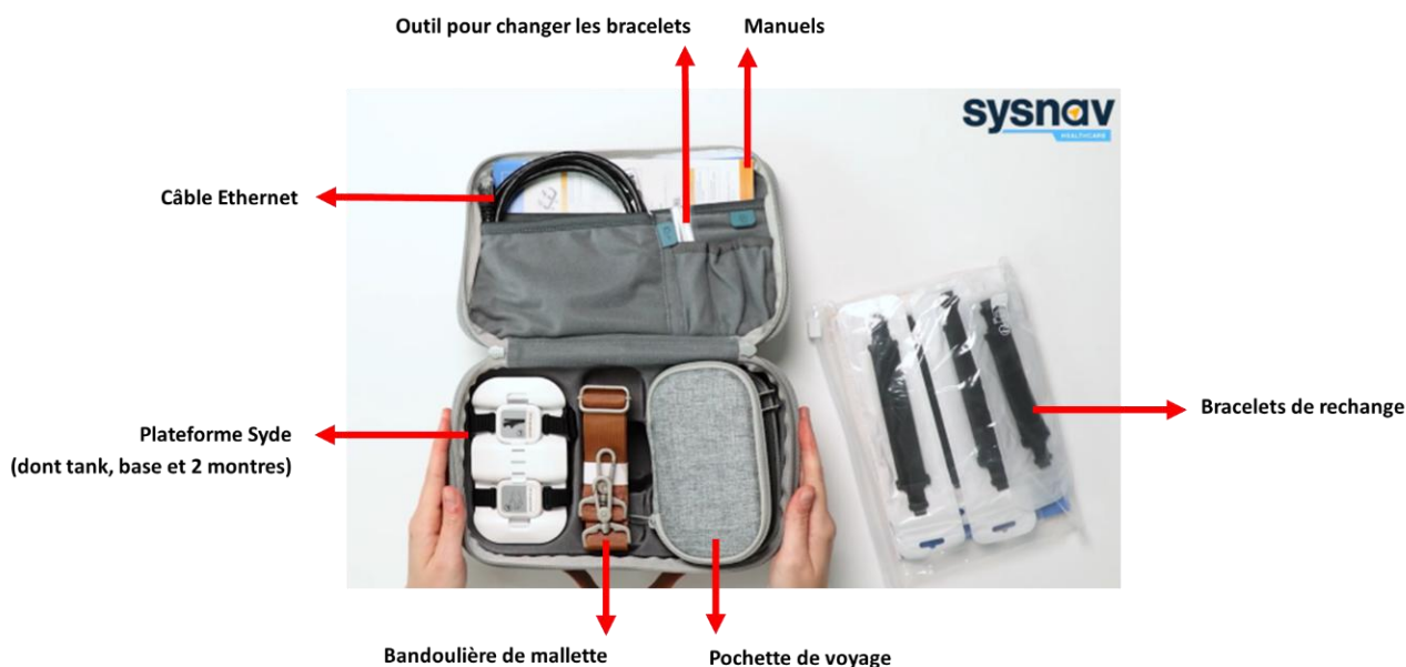
Figure 10 : MALETTE SYDE ® (SOURCE : SYSNAV, 2026) [12] LES FLECHES ET LEGENDES ONT ETE AJOUTEES SUR L'IMAGE ORIGINALE
