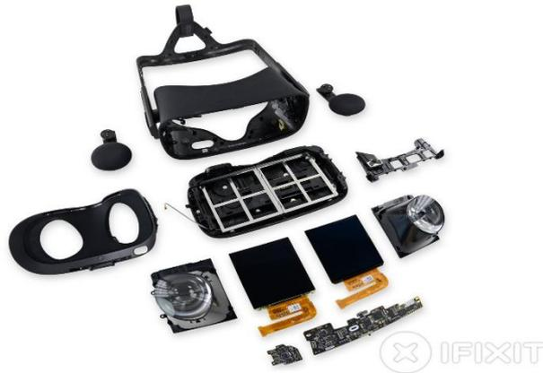
Figure 1 – Une vue "en éclaté" de l'Oculus Rift CV1 [10].
