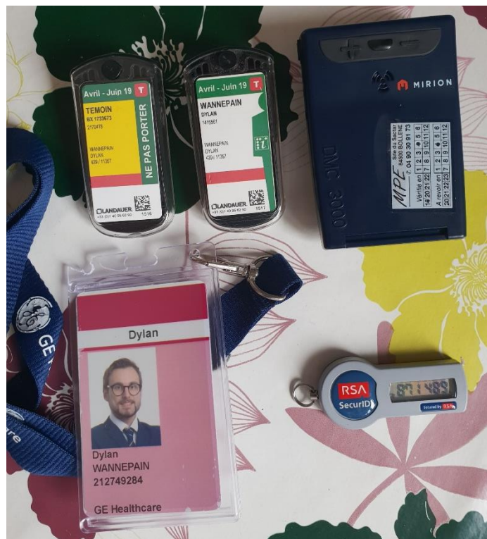
Figure 23 : Photographie du dosimètre témoin, actif et passif (en haut, respectivement de gauche à droite), du Badge (en bas à gauche) et du hard token (en bas à droite)
