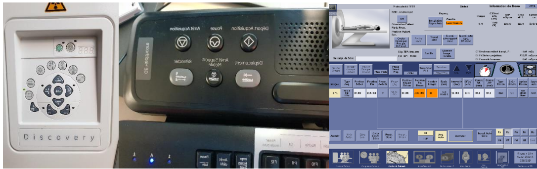
Figure 10 : Photographie des éléments présentés aux MERM, (à Gauche) le panneau de contrôle, (au Milieu) la console d'acquisition, (à Droite) les paramètres d'acquisitions.
