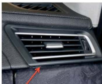
Exécution d'un détail dans une voiture haut de gamme : visibilité d'éléments techniques ( fixations et colle)
