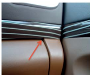
Choix des couleurs et matières et exécution de l'assemblage dans un véhicule très économique
