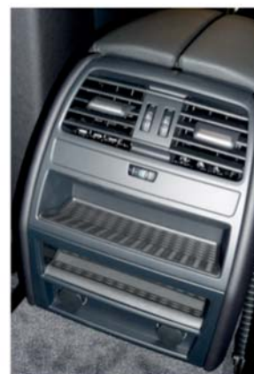
Style et Choix des couleurs et matières dans une voiture haut de gamme : Aspect pauvre de l'exécution renforcé par des différences de couleur notables.
