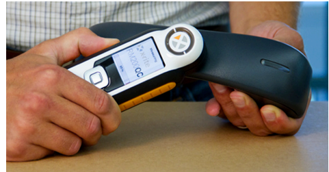
Figure 26 : Exemple Spectrocolorimetre (instrument couleur)
