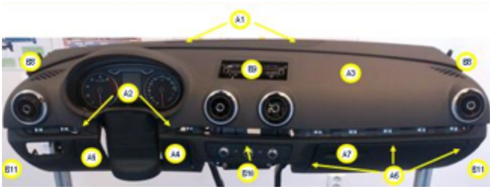
Figure 21: exemple des risques identifiés sur une planche de bord
